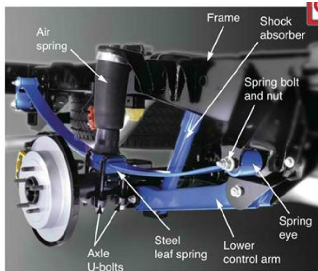
চিত্র: লিফ স্প্রিং-এর উপাদানগুলি চিহ্নিতকরণ
