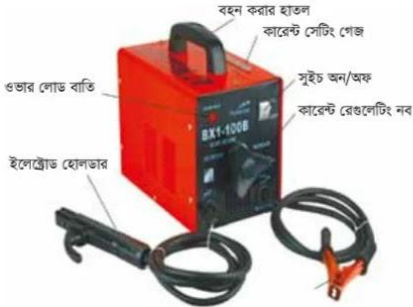
আর্ক ওয়েল্ডিং মেশিনের প্রধান অংশ (Main parts of arc welding machine)
