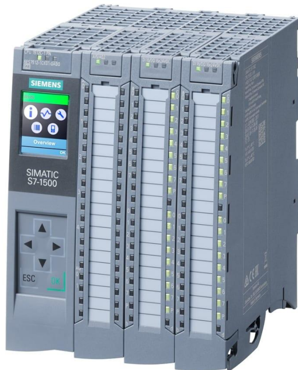
Fig: Siemens S7 1500 PLC
